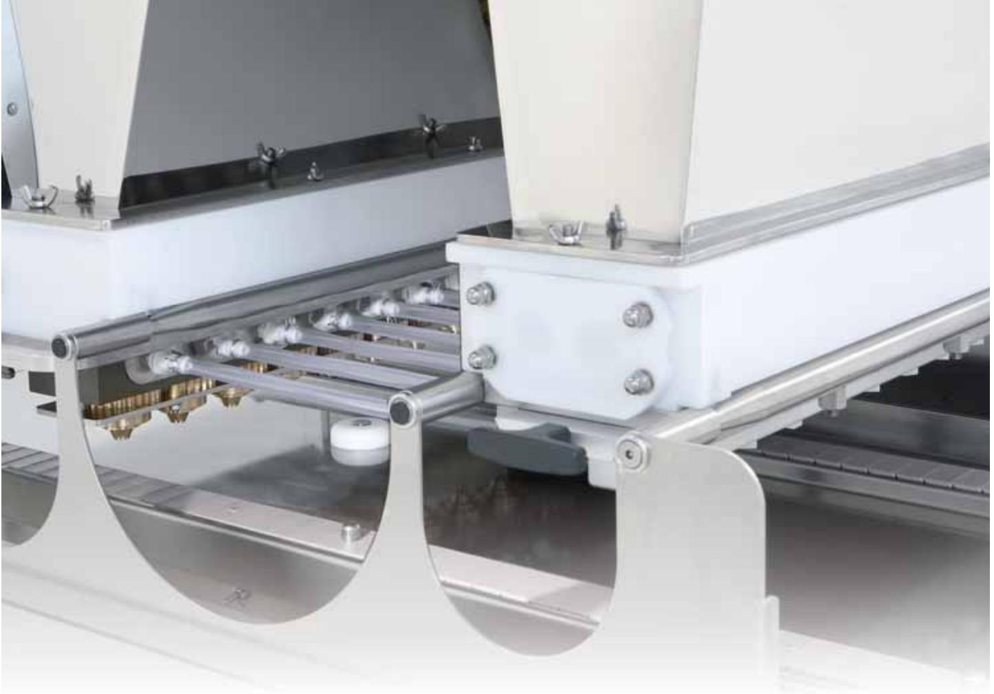
Gruppo di dosaggio (optional) per la produzione di prodotti ripieni completo di stampo e tubi di collegamento per testata a pompa.
